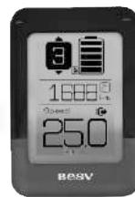
**Einschalten:** Stellen Sie sicher, dass der Akku korrekt am Fahrrad montiert ist und der Ein-Aus-Schalter auf „ON“ (rot) steht. Über das Display können Sie prüfen ob das System eingeschaltet ist. Die Startanzeige auf dem Display sieht wie auf dem Bild dargestellt aus. Es werden Unterstützungsstufe, Akkuladezustand, Gesamtkilometer und Geschwindigkeit angezeigt.
