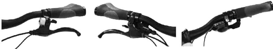
Se si tirano le leve del freno troppo vicino alla manopola, quando si frena violentemente potrebbe non essere possibile usare il freno fino in fondo. Questo aumenta la distanza di frenata, causando il rischio di incidenti. Si prega di regolare le leve del freno come detto prima.
