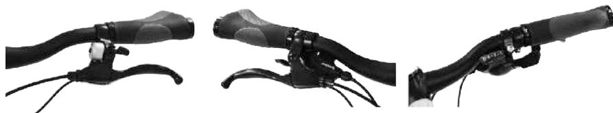
브레이크 레버를 손잡이에 닿을 정도로 너무 세게 당기면 브레이크 기능을 다할 수 없으며 브레이크 제동 거리 증가를 야기해 사고를 유발할 수 있습니다. 위 설명대로 브레이크 레버를 조정합니다.
