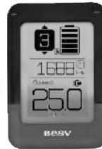
**Aanzetten:** Verzeker u ervan dat de accu goed is geïnstalleerd en er op het accuvergrendeling het rode lampje "ON" brandt, dat de meters zichtbaar zijn, en dat het systeem aanstaat. Op de meters verschijnt het hoofdmenu met een afbeelding, met de ondersteuningsstand, de accumeter, de totale afstandmeter en de snelheidsmeter.
