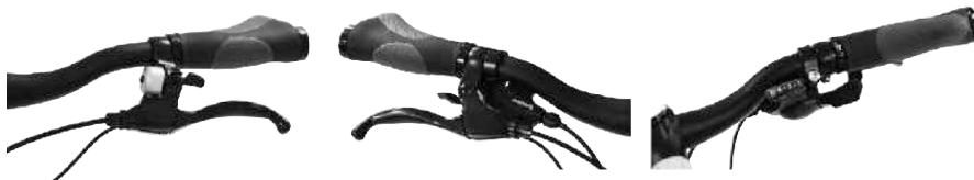
如果您拉煞車控制桿至手把，用力煞車時，您不能將它的煞車力加到全滿。它將導致煞車的距離增加，會有意外的危險。請依據以上所述的調整煞車桿。
