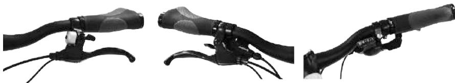
如果您拉煞车控制杆至手把，用力煞车时，您不能将它的煞车力加到全满。它将导致煞车的距离增加，会有意外的危险。请依据以上所述的调整煞车杆。
